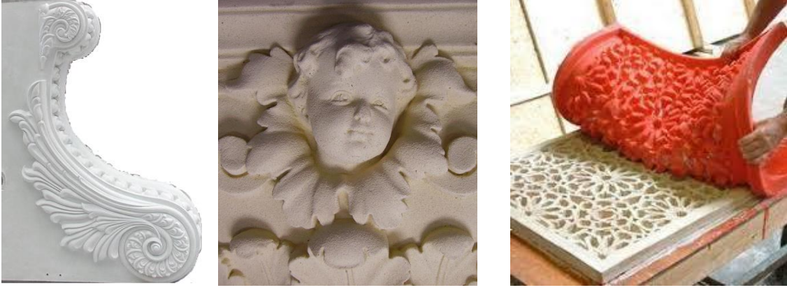
Şekil 1.6 Farklı şekil, form, bezeme ve boşluklu GFRP panellere örnekler.
