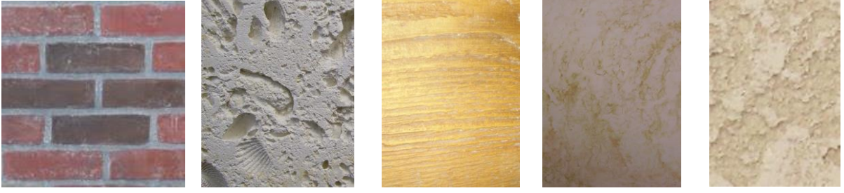
Şekil 1. 4. GFRC panellerin yüzey renk ve dokuları
