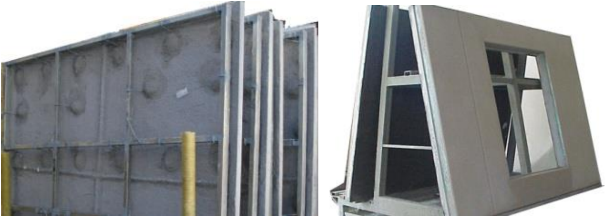
Şekil 1.5 a) Çelik karkaslı GFRC panel b) Isı yalıtımlı GFRC panel[15]
