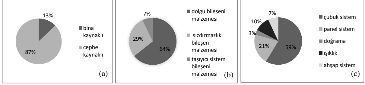
Şekil 4.2 Hasarların sistem-bileşen ilişkisine göre değerlendirilmesi (a), Sistem bileşenlerinde görülen hasarlar (b) ve İncelenen örnekler arasında hasar oranı (c)
