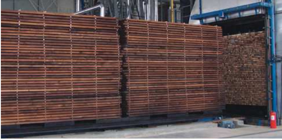
Resim 2: Isıl işlem uygulama fırını(15)
