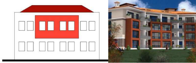
Şekil 7. Cephe kaplama tuğlasının uygulandığı bina yüzeyinde kütleli etki
