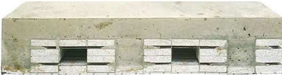
Şekil 4. Betonlanmış döşeme panelinin kesiti [5]
