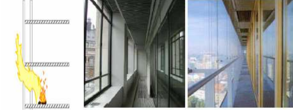
Şekil 9. Kat yüksekliğindeki yangın anındaki alevin yayılma davranışı (a) ve cepheler (b) [16]
