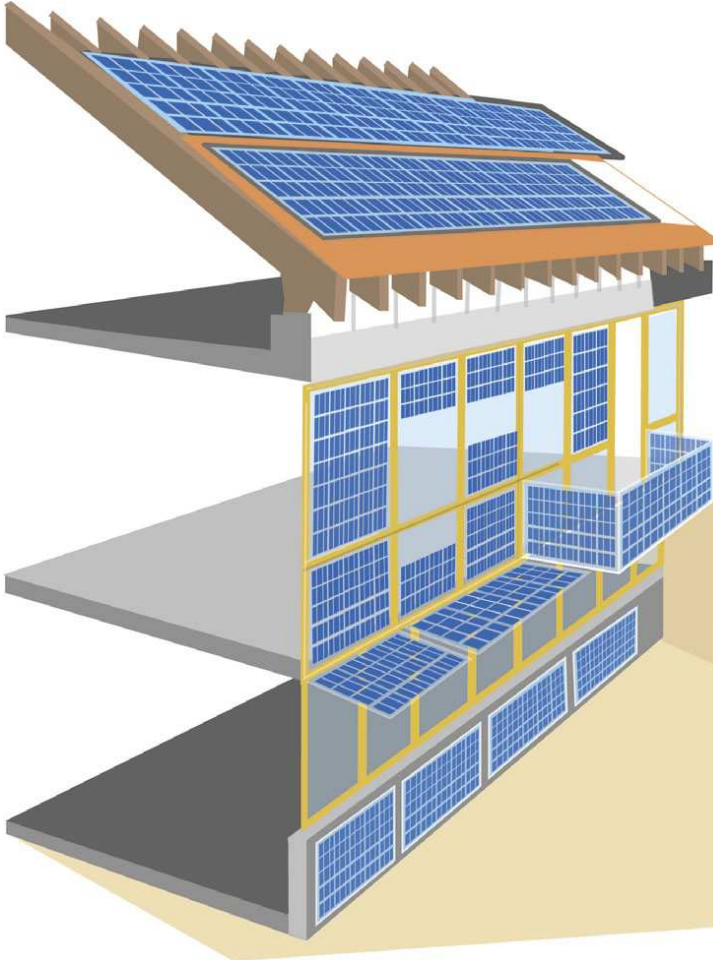
Şekil- 6 Bina çatı ve cephesine entegre fotovoltaik panellerin şematik gösterimi
