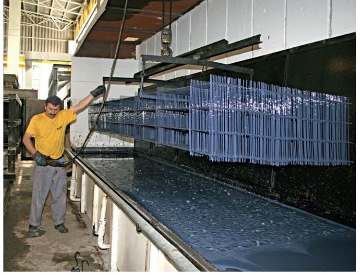
Fotoğraf 3: Çelik hasır donatıların korozyona karşı kaplanması
