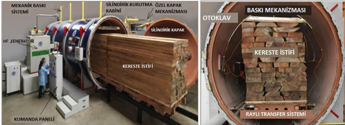
Resim 8. Yüksek Frekans - Vakum Kombinasyonlu Kurutma Tekniği
