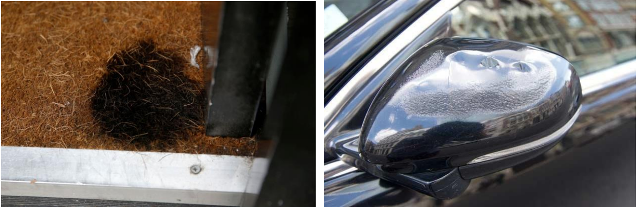
Resim 4: Yansıyan ışığın komşu binadaki dükkanın giriş kapısındaki paspasta oluşturduğu yanık ve sokakta park halinde bulunan bir Jaguar marka aracın boyasındaki oluşturduğu tahribat.
