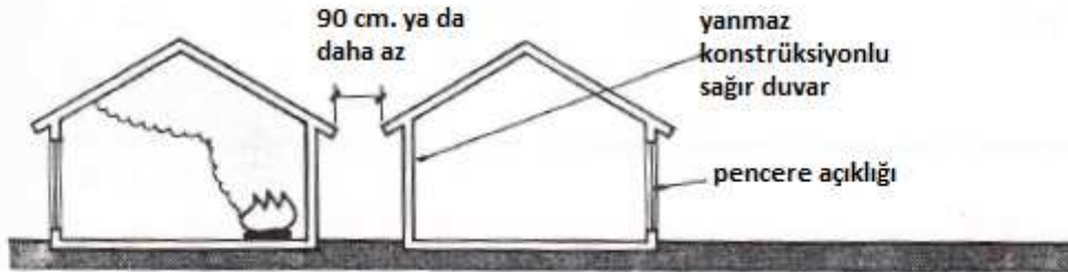
Şekil 11. Komşu binalar arasında Yangının yayılmasının engellenmesi [10].
