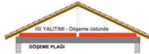
Resim 1. Soğuk çatı detayı [7].
