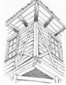
Çizim 2. Tek tabanlı karkas çatki kuruluşu, [4]
