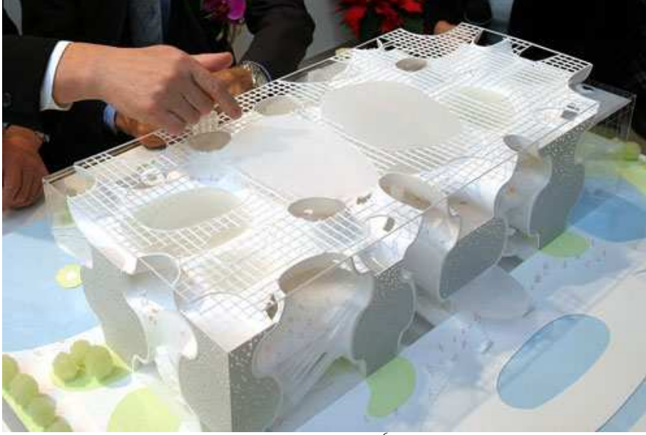
Şekil 3. Toyo Ito'nun bir strüktür çalışma modeli. 6 Taichung Metropolitan Opera Binası, 2005, Tayvan. Bütün modernist binada strüktür adına ne varsa odur. Bir grid aynı topolojik formül üzerinden deforme ediliyor. Bütün binada gördüğümüz ne varsa o topolojik örtüden ibaret olmuştur.
