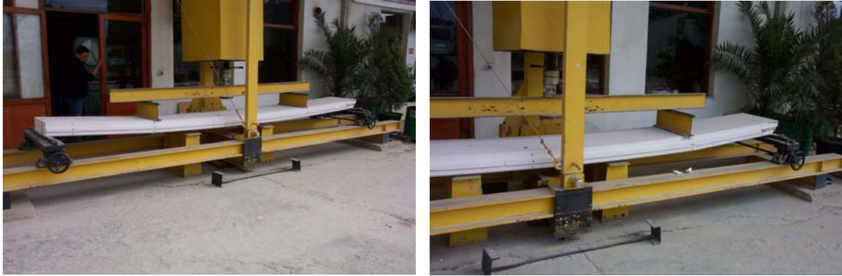
Şekil 1. Donatılı Çatı Plaklarında Prototip Yükleme Deneyi
