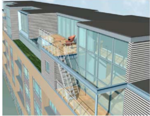
Şekil 4. IFD-Binaları Çatı-üstü Uzantı Uyarlaması
